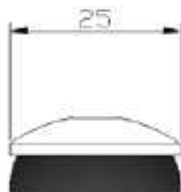
Těsnicí podložka EPDM s hliníkovou podložkou, Ø 25 mm
